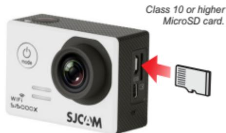
Inserire una scheda MicroSD, come mostrato nella figura qui sopra, con l'etichetta rivolta verso lo schermo LCD, fino a quando non scatta in posizione. Per rimuovere, basta spingere delicatamente e la scheda verrà espulsa. NOTA: Per essere sicuri di non perdere alcun dato, rimuovere o inserire la scheda mentre la fotocamera è spenta.
