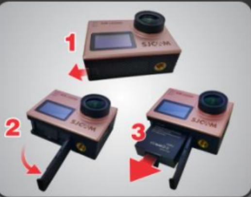
Rimuovere la batteria sbloccando lo sportellino facendolo scorrere nel verso della freccia in esso indicata, questo si solleverà permettendo l'estrazione della batteria. La batteria può essere ricaricata con un caricatore doppio esterno (non visualizzato in foto, venduto separatamente come accessorio).
